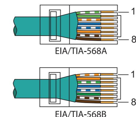
Последовательность расположения пар проводников в разъеме определяется стандартами EIA/TIA-568A и EIA/TIA-568B.
