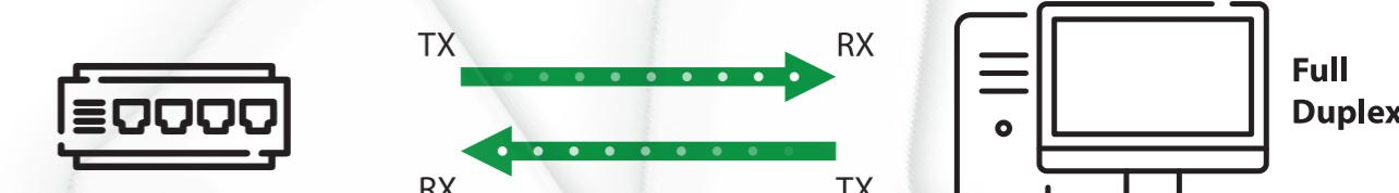
В полнодуплексном режиме (full-duplex) оба узла, имеющие соединение «точка-точка», могут принимать (RX) и передавать (TX) данные одновременно. Для этого каждый узел должен быть подключен к выделенному порту коммутатора.
