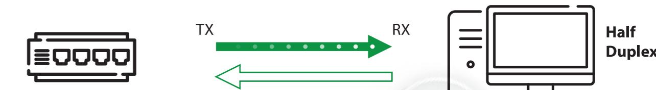
В полудуплексном режиме (half-duplex) узел может только принимать (RX) или передавать (TX) данные в один момент времени, при условии получения доступа к среде передачи.
